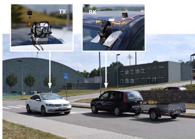
Měření kanálu pro V2V komunikaci v pásmu 60 GHz
